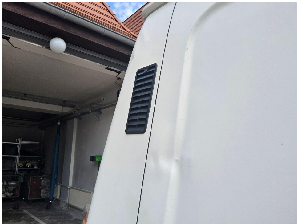
Bild 26 : Lackabplatzer, Korrosion, Dellen
