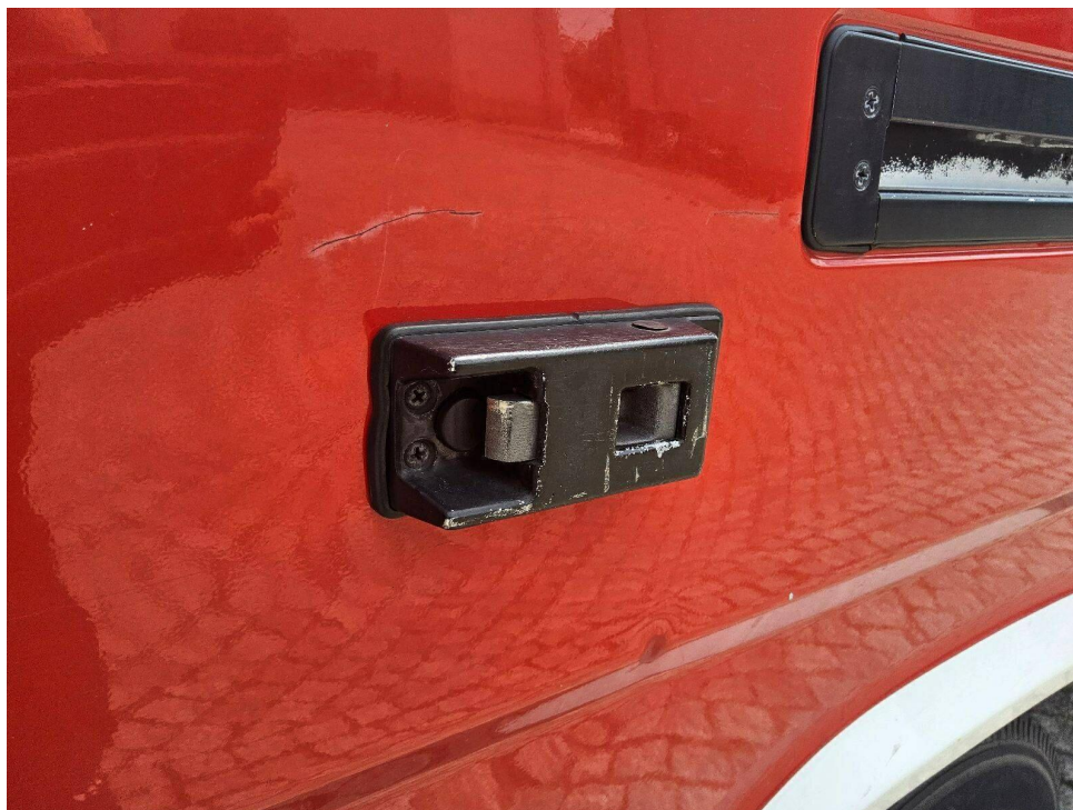
Bild 29 : Lackabplatzer, Korrosion, Dellen
