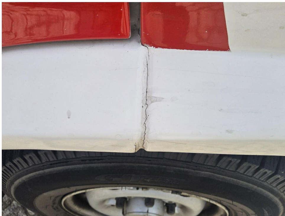
Bild 20 : Lackabplatzer, Korrosion, Dellen
