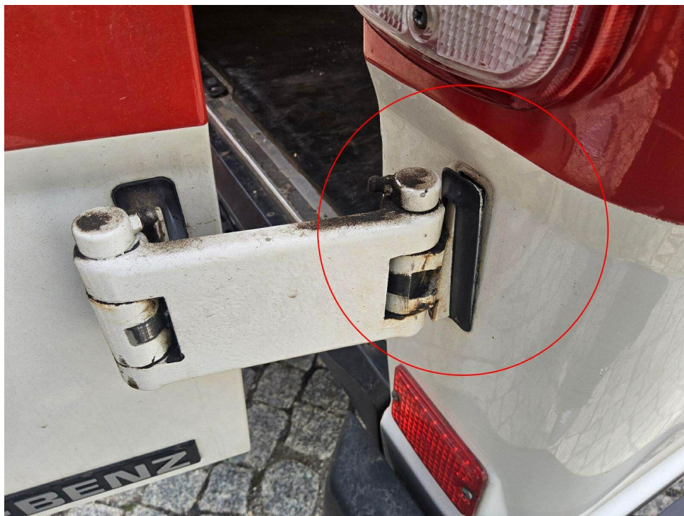
Bild 21 : Hecktür rechts Türschanier lose
