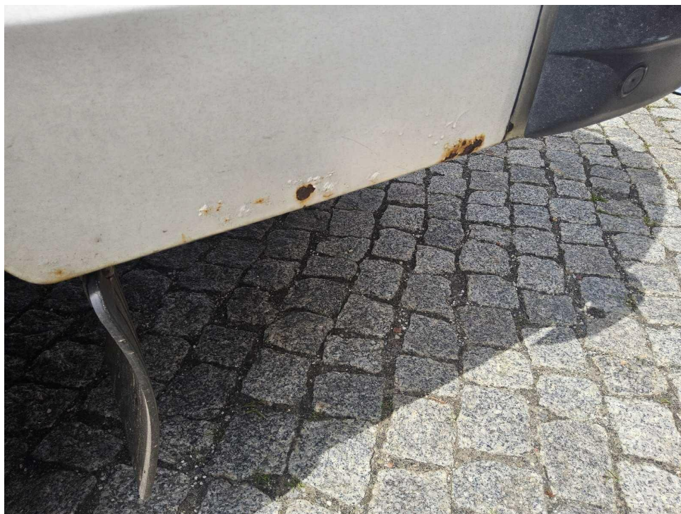
Bild 23 : Lackabplatzer, Korrosion, Dellen
