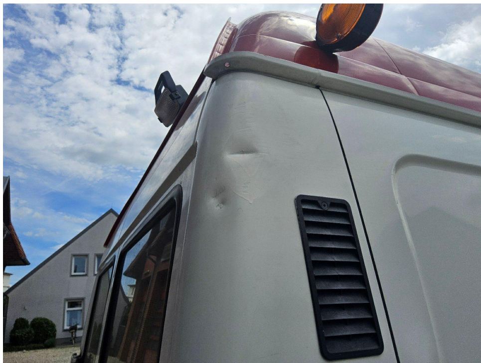
Bild 27 : Lackabplatzer, Korrosion, Dellen
