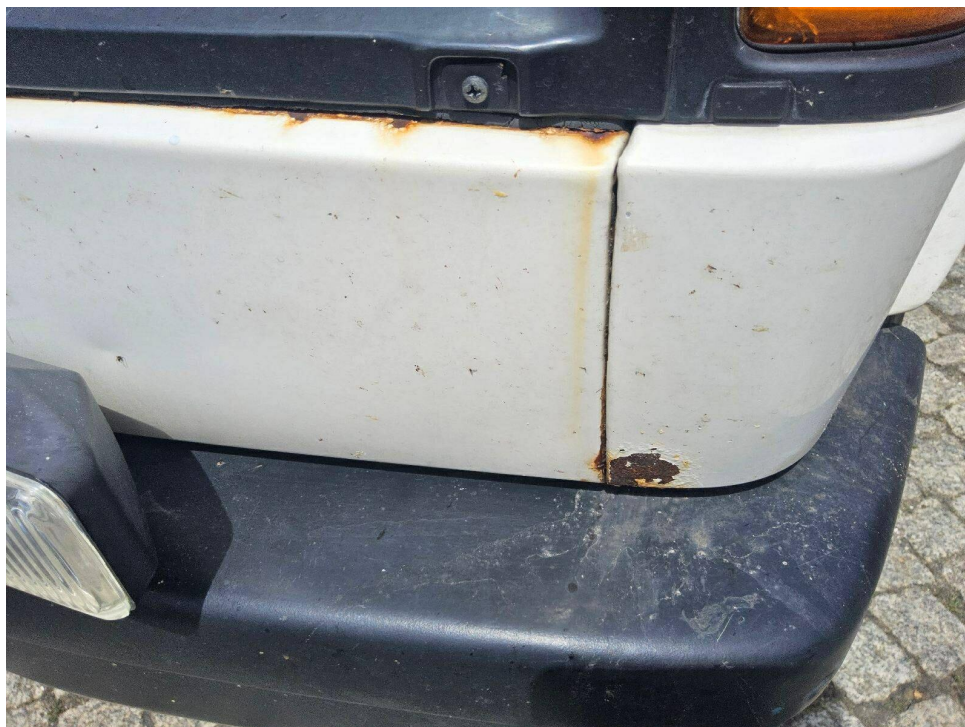
Bild 28 : Lackabplatzer, Korrosion, Dellen
