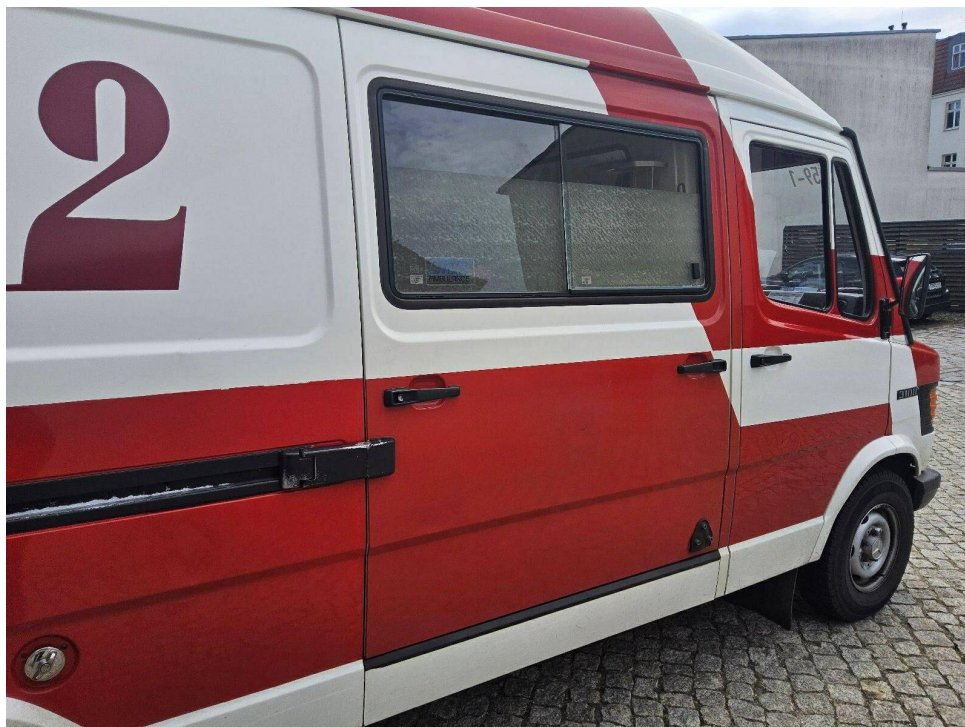
Bild 24 : Schiebetür rechts klemmt, nicht Öffnbar
