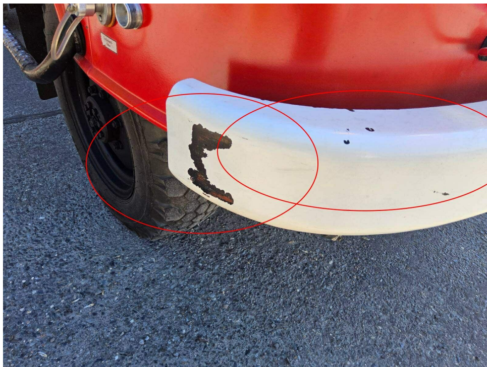
Bild 21 : Stoßfänger vorne zerkratzt
