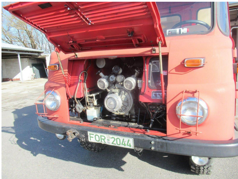
Bild 19 : Frontansicht Mit Löschpumpe
